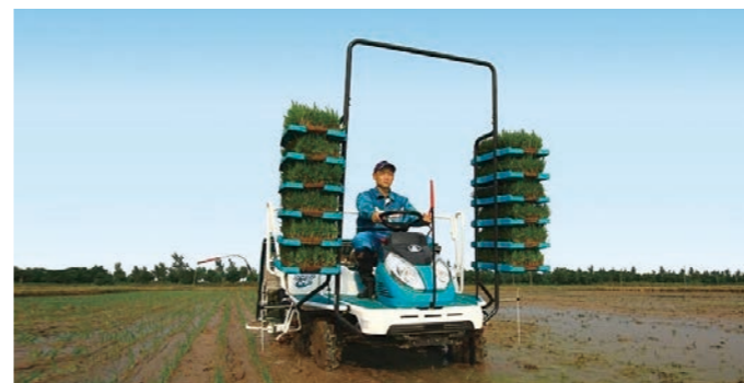
插秧机 将水稻秧苗转插至水田。可大幅节省人力、减轻劳动强度。
