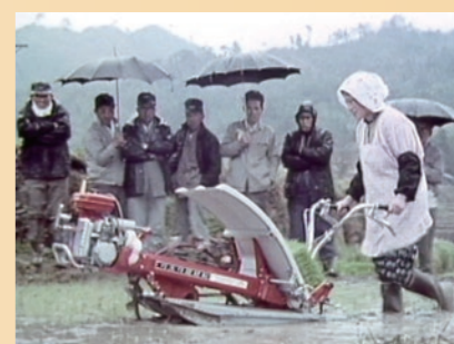
插秧机系列产品的雏形——行走式全自动插秧机 (SPS型)
