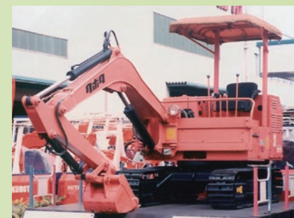
后来的久保田小型挖掘机系列的雏形——完全旋转式小型油压挖掘机 (KH1型)
